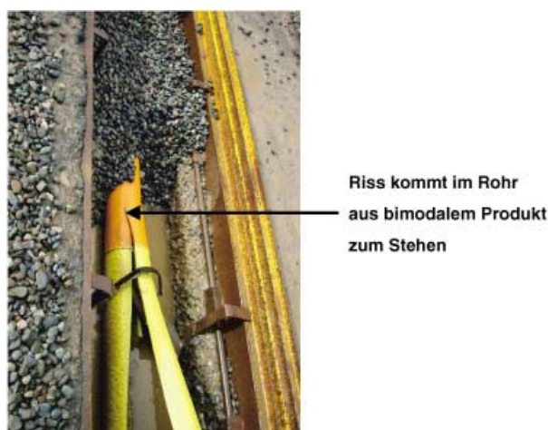
Abbildung 33. Praxistest zum schnellen Risswachstum (Advantica Technologies Ltd.).
